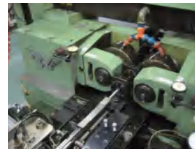
通过滚丝模进行的冷轧加工 Rolling process by Rolling dies
