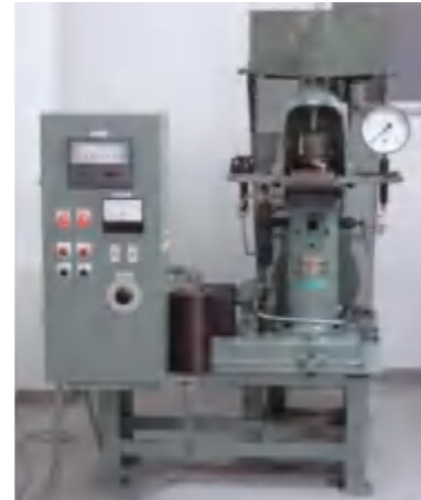
照片 B-14：曾田式四球磨损试验机 Photo B-14：SOTA-4-Ball wear test machine
